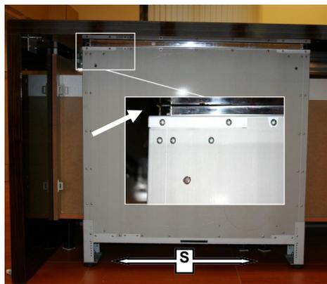
La cappa da piano permette una regolazione in altezza della struttura da 820mm a 900mm partendo dal pavimento al sotto piano. Questa regolazione è possibile agendo sui piedini e sui supporti piedino (Fig. 1).
