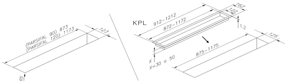
Při instalaci digestoře nastavte výšku nohou "S" tak, aby bylo možné umístit digestoř pod kuchyňskou pracovní desku.
