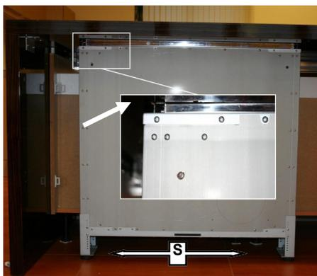
Digestoř je dodána s krytem kloubově uchyceným po stranách. Kryt může být ocelový (součástí dodávky s down draft v nerez provedení), skleněný (součástí dodávky s down draft ve skleněném provedení) nebo ze stejného materiálu jako horní část kuchyně (nedodáván, MAX 7Kg). Je nutno precizně nalepit kryt po ukončení montáže digestoře. Prostor mezi krytem a otvorem v desce musí dosahovat cca 1,5 mm podél celého obvodu.
