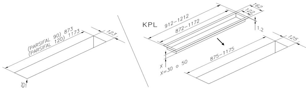
Per installare la cappa, regolare l'altezza dei supporti piedino "S" in modo da poter posizionare la cappa sotto al top cucina. Alzare la cappa con i piedini fino a far appoggiare la struttura della cappa al top cucina.
