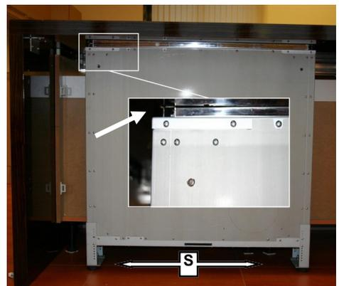
Die Tischhaube macht eine Regulierung der Höhe der Struktur von 820 mm bis 900 mm möglich, gemessen vom Fußboden unter dem Kochfeld. Die Regulierung erfolgt über die Stellfüße und die Halterungen der Füße (Abb. 1).
