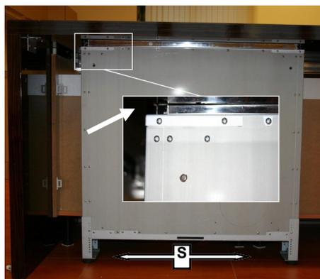
De downdraft kan onder het werkblad op een hoogte van 820mm tot 900mm van de vloer afgesteld worden. Deze afstelling kan gebeuren via de voetjes en de voetsteunen (afb.1).
